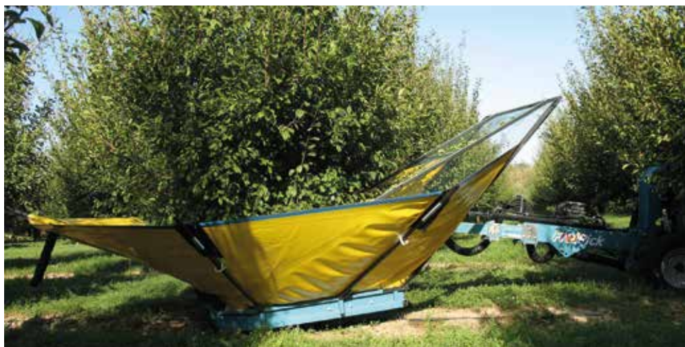
La macchina scuotitrice telecomandata per la raccolta delle olive
