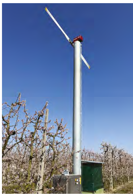
Un "ventolone" installato in un frutteto di albicocchi
