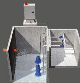
STAZIONI DI SOLLEVAMENTO
