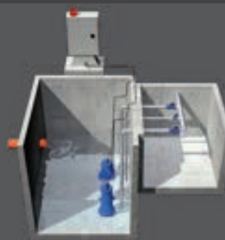
STAZIONI DI SOLLEVAMENTO
