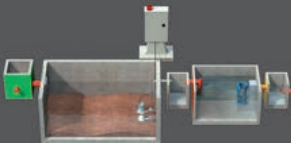
IMPIANTI DI PRIMA PIOGGIA
