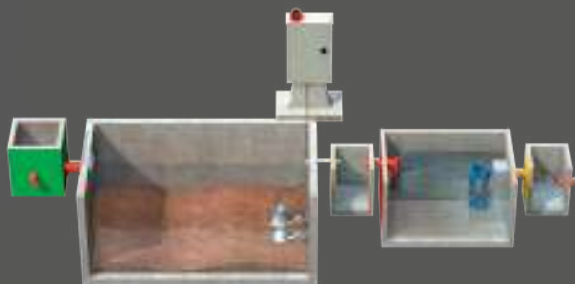
IMPIANTI DI PRIMA PIOGGIA
