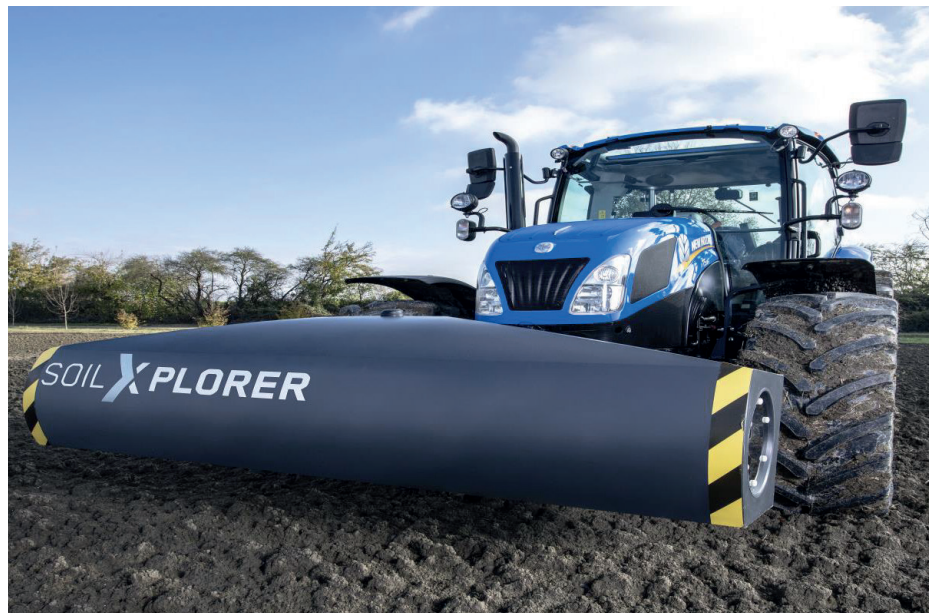
Lo strumento di rilevazione della struttura del terreno denominato Soilxplorer
