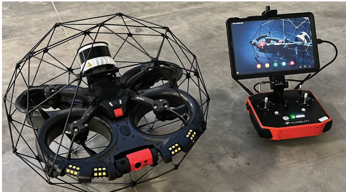
Il drone in grado di realizzare ispezioni e mappature in spazi confinati, in dotazione alla cooperativa Forlì Ambiente
